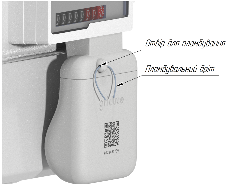
Рисунок 5 – Схема пломбування модемів
