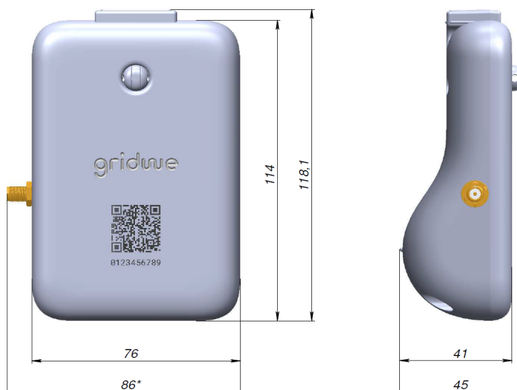
Рисунок 1 - Габаритні розміри модему
